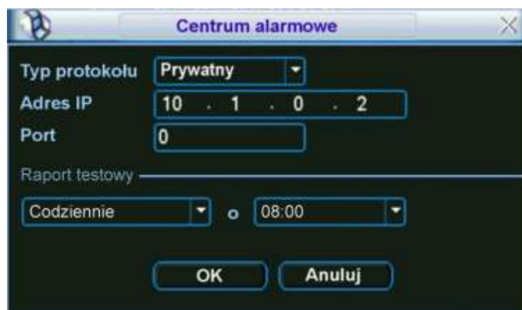
Rys. 5-17. Ustawianie serwera alarmowego.
