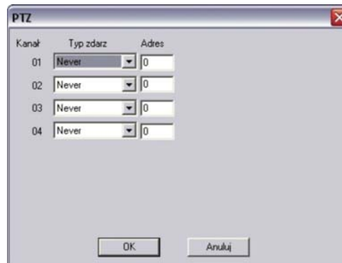
Rys. 7-42a. Ustawienia PTZ w reakcji na detekcję ruchu, zanik obrazu Video lub zasłonięcie kamery.
