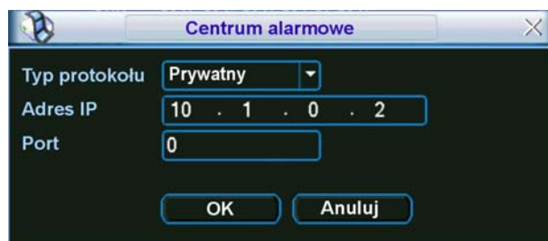
Rys. 5-17. Ustawianie serwera alarmowego.
